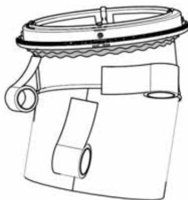
Figure 6-b - Tube collecteur pré-assemblé pour système « SOLATUBE® », série Brighten Up® : liaison avec le corps du conduit.
