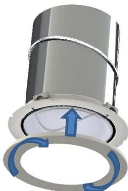
Positionner le diffuseur sous la collerette du kit inférieur et réaliser une rotation quart de tour dans le sens horaire pour le maintenir en position. Une fois cette étape réalisée le diffuseur est alors fixé sous le plafond, l'installation est terminée, le disque occultant peut être utilisé à volonté.
