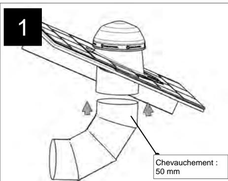
Former l'angle des rotules avant d'installer le tube coudé intermédiaire.
