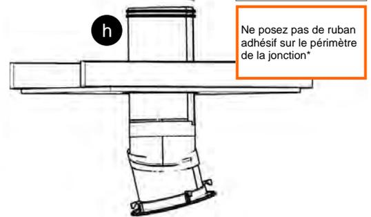
\* Posez uniquement du ruban adhésif sur la jonction s'il s'agit d'une installation sans plafond (tube suspendu).
