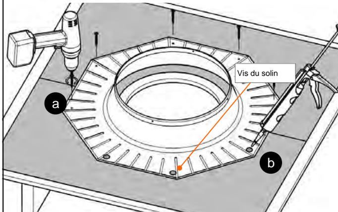
**6** Appliquez le mastic d'étanchéité à l'extérieur et étalez uniformément (à l'aide d'une raclette par exemple)
