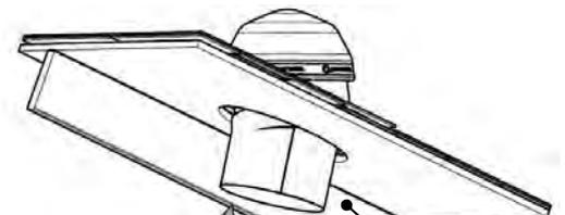
Insérez le tube inférieur (ou la rallonge) dans le tube supérieur.
