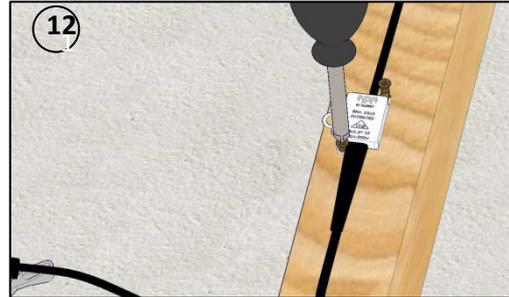
Vissez le boîtier de connexion sur un support accessible.
